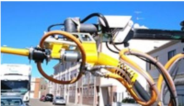
La boquilla de proyección, o pincel, tiene tres motores hidráulicos que permiten que pueda rotar en 2 ejes (axial y radial) y efectuar el movimiento de nutación.
