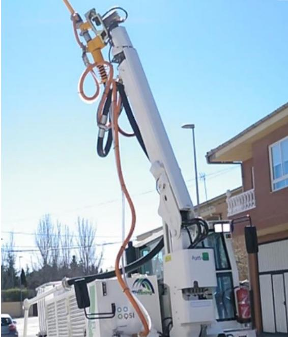
La Duodécima cuenta con un brazo extraíble de dos tramos, por lo que el rango de trabajo es muy amplio. La Duodécima puede gunitar en un rango que oscila entre menos de 2 metros hasta 7 metros en sentido horizontal; y 13 metros en sentido vertical (9 metros hacia arriba y 4 hacia abajo)
