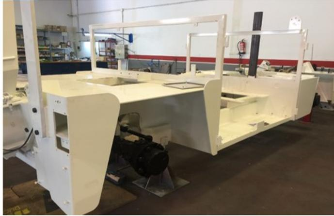
El chasis de la gunitadora Duodécima está diseñado y construido para resistir las condiciones más exigentes en términos de torsión e impacto.
