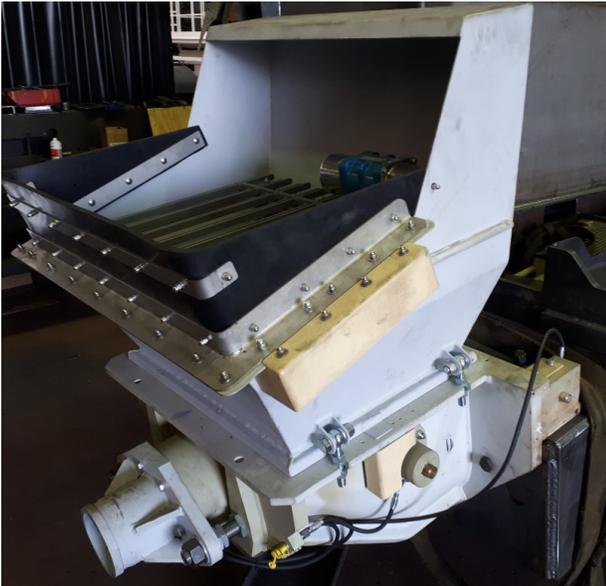
La Duodécima equipa una bomba de hormigón Aliva 272, que puede ser activada tanto de modo eléctrico como en diésel. Dicha bomba cuenta con vibrador y agitador.
