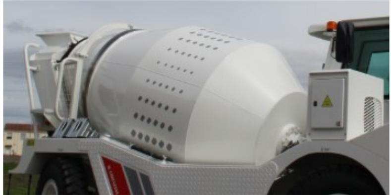
Las operaciones de carga, amasado y descarga se ven optimizadas por el diseño de la cuba, centrándonos en sus dimensiones, ángulo de inclinación y construcción de las espas.
