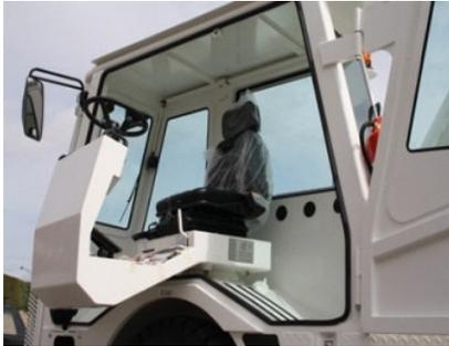
El puesto de conducción puede girar 180 °, de manera que el operario siempre pueda ver hacia dónde se dirige. Al cambiar el sentido del puesto también se cambia la dirección para la circulación en sentido de la marcha.
