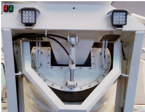
El HURÓN 4 Full cuenta con una tapa hidráulica que permite transportar todo el hormigón sin que se produzca pérdida de contenido, independientemente del terreno por el que se circule.
