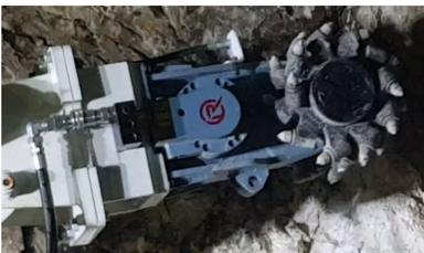
Esta fresadora permite horadar el techo del túnel. De esta manera se puede avanzar en la excavación del mismo.
