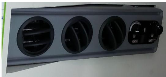
El Scaler tiene climatizador para que el operador pueda manejar la máquina en las mejores condiciones posibles de seguridad y comodidad.
