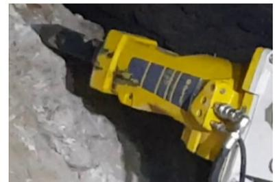
El martillo hidráulico sirve para desatar la roca, es decir, para desprender roca ya agrietada.
