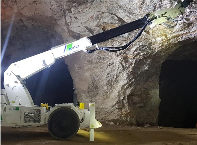
El Scaler incorpora un brazo con 3 tramos desplegados que se puede adaptar a trabajos en distancias que oscilan entre menos de dos metros hasta 10,4 metros de altura y 9,7 metros en sentido horizontal.
